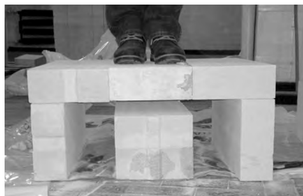
Rys. 17. Próby własne bloczków połączonych za pomocą kleju poliuretanowego SOLBET SMART.
