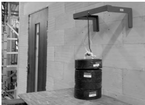
Rys. 7. Obciążenie półką – obciążenie mimośrodowe 1000 N.
