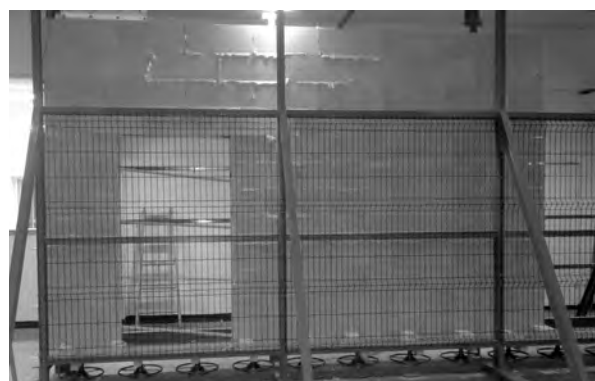
Rys. 15. Badanie ściany na podatnych i odkształcalnych podłożach.
