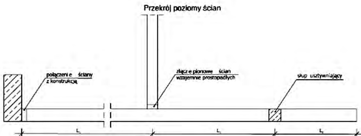
Rys. 1. Usztywnienia pionowe ścian wypełniających.
