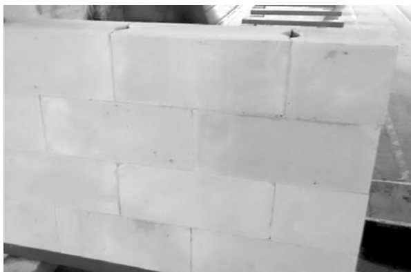
Rys. 13. Wygląd modelu badawczego do badań muru na zginanie (rozciąganie przy zginaniu).
