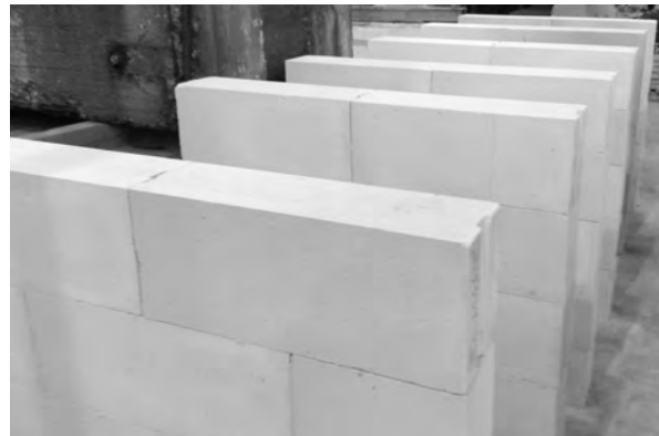
Rys. 14. Wygląd modeli badawczych do badań wytrzymałości muru na zginanie (rozciąganie przy zginaniu).
