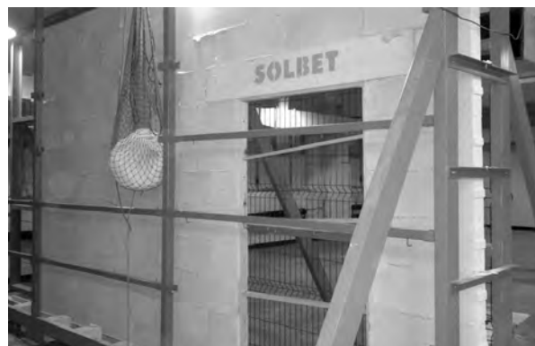
Rys. 16. Badanie wewnętrzne – uderzenie ciałem miękkim-ciężkim.
