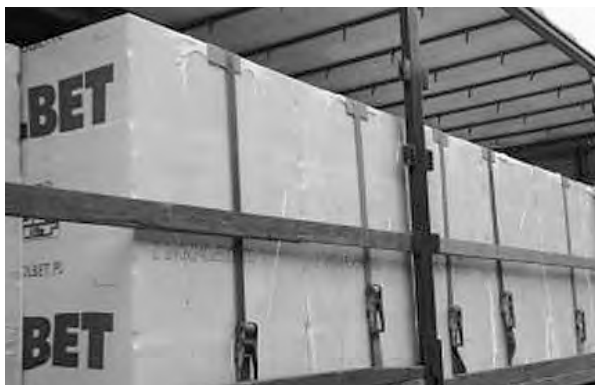
Rys. 1. Prawdłowe zabezpieczenie materiału w czasie transportu.
