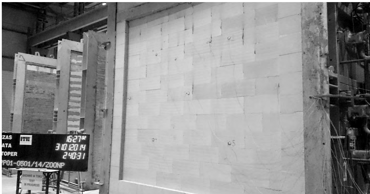
Fot. 12. Wygląd ściany po 240 minutach badania.
