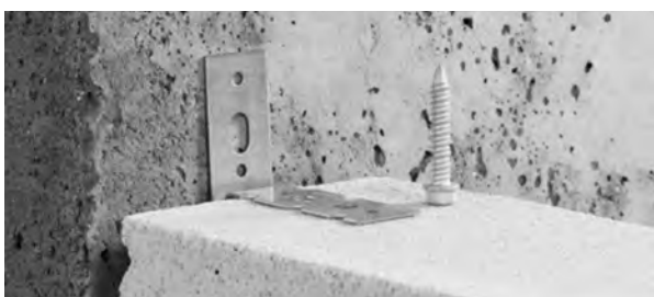
Rys. 9. Łącznik D1 ze stali ocynkowanej do łączenia ścian działowych z żelbetowymi elementami konstrukcji budynku z zachowaniem możliwości niezależnych odkształceń.
