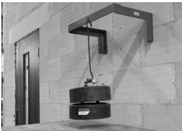
Rys. 6. Obciążenie półką – obciążenie mimośrodowe 500 N.
