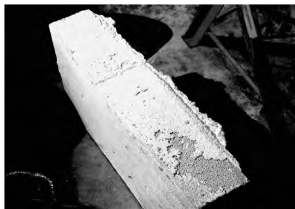
Rys. 11. Powierzchnia oderwanego bloczka.
