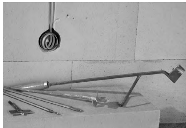
Rys. 24. Zestaw narzędzi do wykonywania przebić i bruzd instalacyjnych w ścianach z betonu komórkowego.
