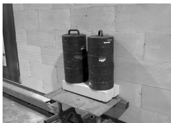
Rys. 10. Próba obciążenia obciążnikami o masie 300 kg. Przy tym obciążeniu półka została oderwana.
