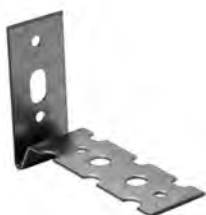
Rys. 10. Łącznik symbol D1 do mocowania ścian działowych do ścian nośnych lub do elementów żelbetowych z zachowaniem przerwy dylatacyjnej [9].
