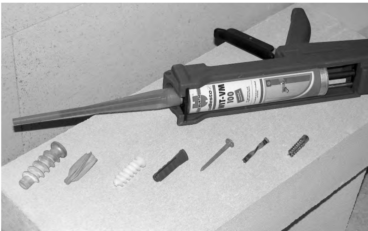
Rys. 28. Różnego rodzaju elementy kotwiące do betonu komórkowego: gwoździe kute, gwoździe skręcane, dyble tworzywowe wbijane, dyble tworzywowe wkręcane, kołki metalowe wkręcane, kołki metalowe wbijane, kotwa iniekcyjna.
