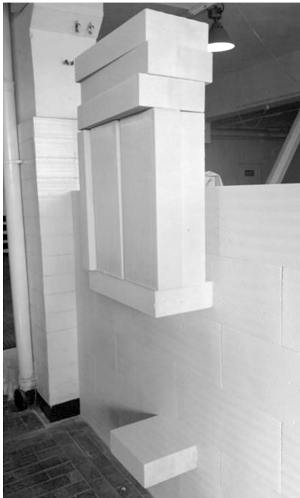
Rys. 19. Próby obciążenia mimośrodowego bloczków przyklejonych za pomocą kleju poliuretanowego.
