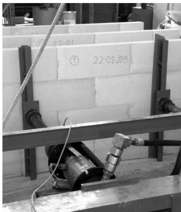
Rys. 4. Mur badany na zginanie.
